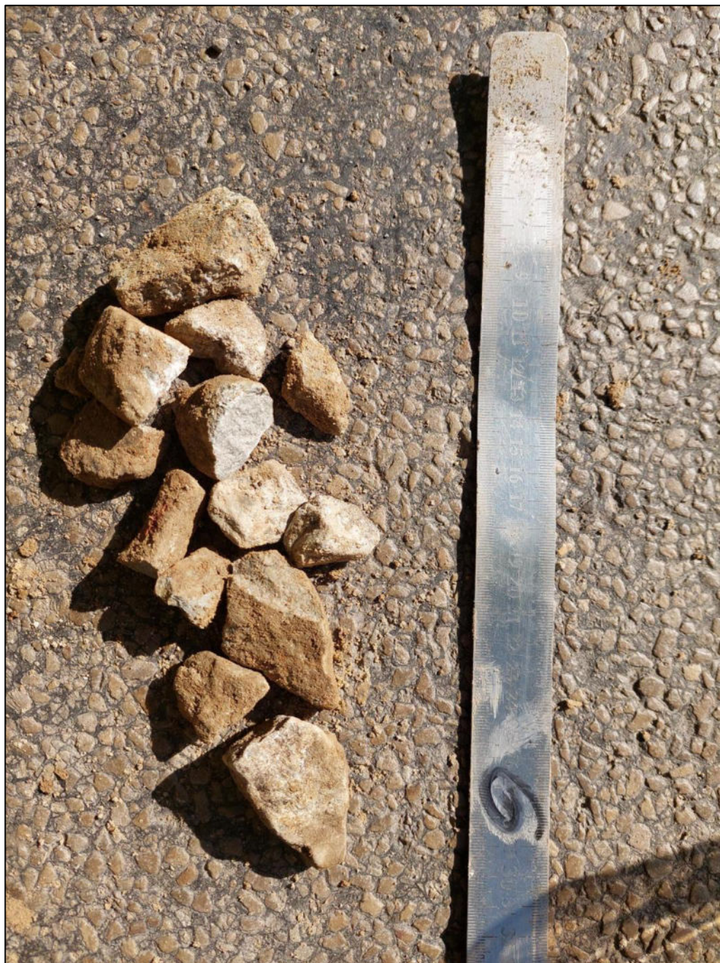
Pav. 3 Dangos pagrindas (skalda) ties gręžiniu Gr.6
